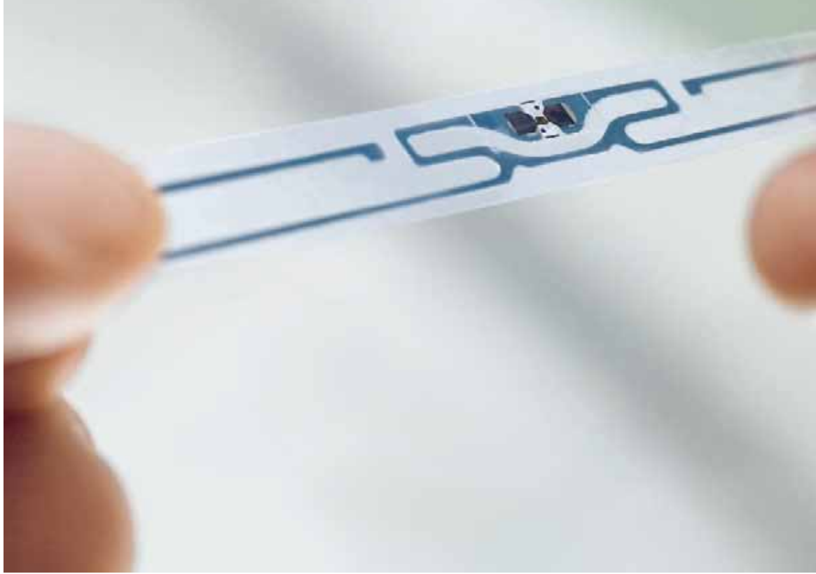
Eine Antenne und ein winziger Computerchip: So sieht ein RFID-Transponder aus.
